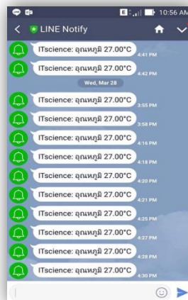
ภาพที่ 12 ตัวอย่างแสดงการแจ้งเตือน Line notify เมื่ออุณหภูมิสูงกว่า 26 °C ตามที่ตั้งไว้จะทำการแจ้งเตือน
