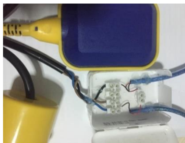
ภาพ 6 การเชื่อมต่อ Float Switch เข้ากับบอร์ด MCU ESP8266
