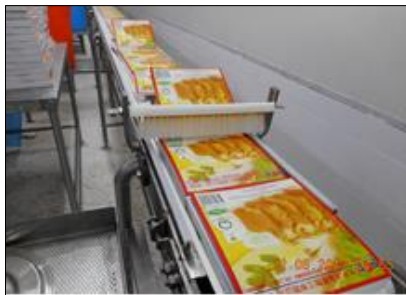
ภาพ 6 หลังปรับปรุงเซตเกล็ดขนมปังที่ติดกล่องปลาทิพย์ด้วยแปรง
