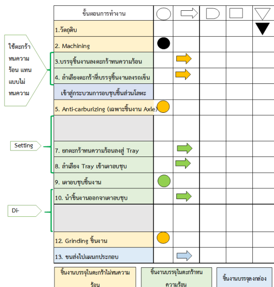
ภาพ 2 ขั้นตอนการผลิตใหม่หลังปรับปรุงใช้ตะกร้าทนความร้อนทั้งระบบ
