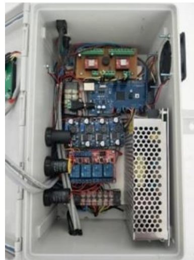
ภาพที่ 9 การติดตั้งอุปกรณ์ภายในและภายนอกตู้ควบคุมเครื่องวัดความกว้างแผ่นฟิล์มพลาสติก
