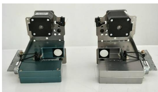
ภาพที่ 15 ส่วนขับเคลื่อนเซนเซอร์วัดความกว้างแผ่นฟิล์มพลาสติก
