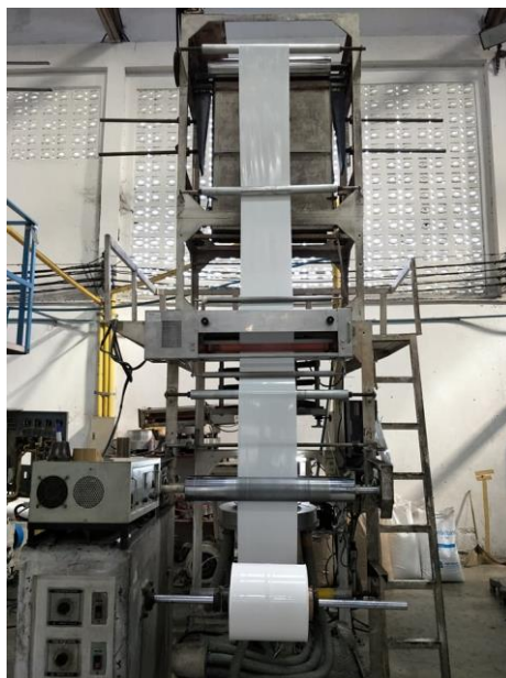
ภาพที่ 1 การทำงานของเครื่องอัดรีดแผ่นฟิล์มพลาสติก บริษัท ปิ๊อปปูล่าร์แพค จำกัด
