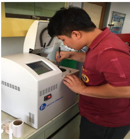
รูปที่ 6 การทดสอบหาค่าความร้อนสูงโดยอุปกรณ์ Parr 6400 Calorimeter
