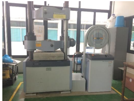
ภาพที่ 6 การกดฉาที่ระบายน้ำจนเกิดรอยร้าว
