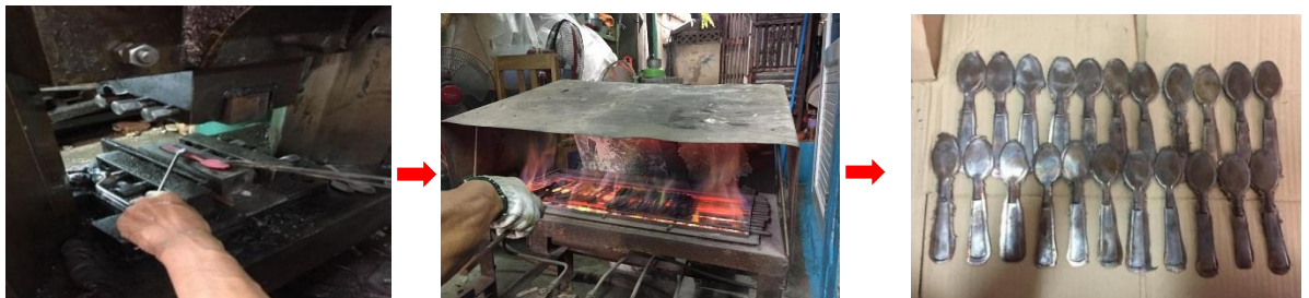
ภาพที่ 14 ทดสอบปั๊มชิ้นงานโดยใช้แม่พิมพ์ที่พัฒนา
