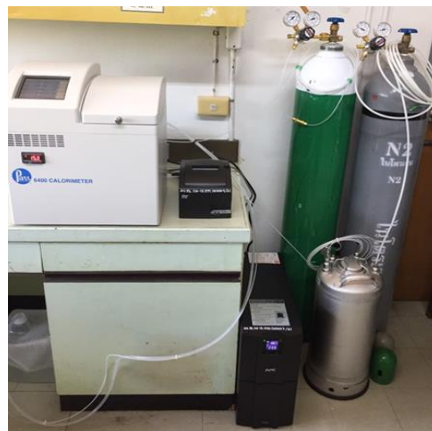
รูปที่ 6 การทดสอบหาค่าความร้อนสูงโดยอุปกรณ์ Parr 6400 Calorimeter
