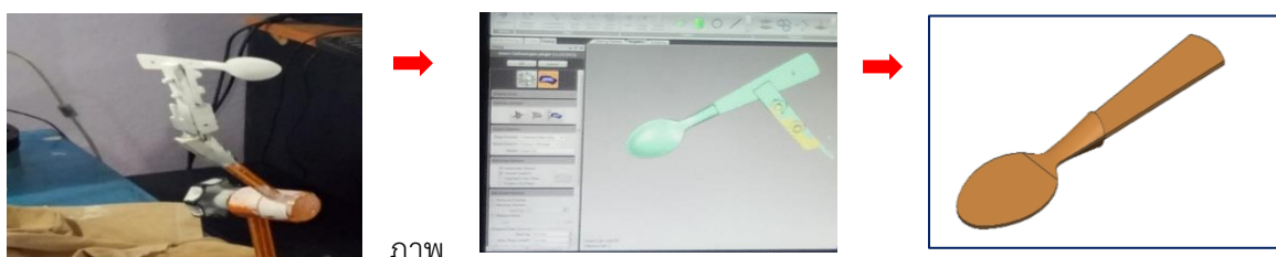
ที่ 10 แสดงผลการออกแบบชิ้นงานทดสอบโดยใช้เทคโนโลยีวิศวกรรมย้อนรอย
