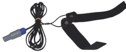
ภาพที่2 อุปกรณ์ช่องตรวจวัดปฏิกิริยาไฟฟ้าที่ผิวหนัง (Electrodermal Response Channel)
